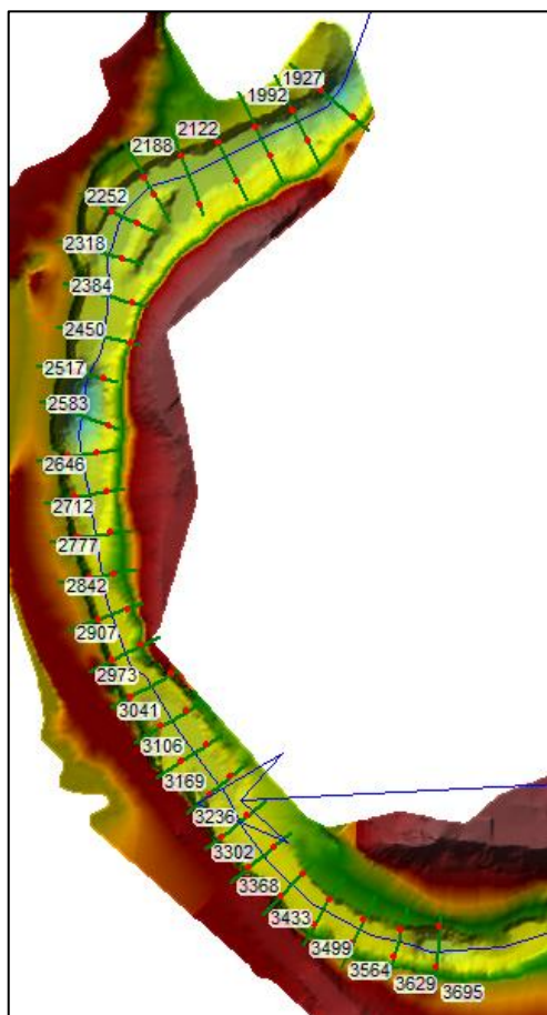
Figura 23 – Localização das seções topobatimétricas no modelo unidimensional HEC-RAS v. 5.0.7
